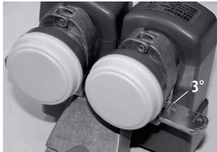
Bild 5: Beispiel für eine Multifeedanordnung
