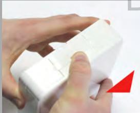
1. Im Auslieferungszustand sind die drei Gehäuseteile des Geräts zusammengesteckt. Trennen Sie diese zunächst voneinander. Drücken Sie mit einer Hand jeweils oben und unten auf die geriffelten Flächen um die Rastnasen im Deckel zu entsperren. Ziehen Sie den Gehäusedeckel nun von den anderen beiden Gehäuseteilen ab. Verfahren Sie dann mit dem mittleren und unteren Gehäuseteil genauso.
