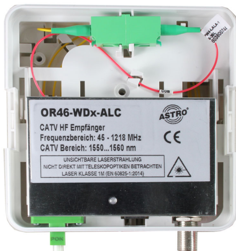
Bild 11: Mittelteil mit HF Empfänger
