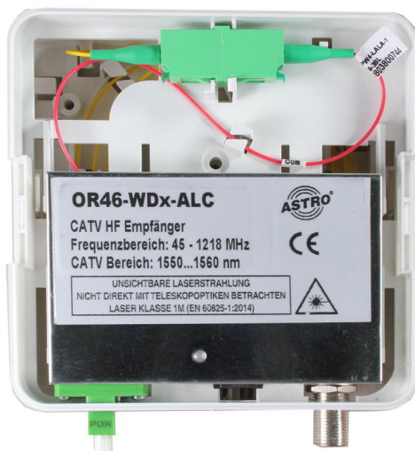
Bild 4: Mittelteil mit HF Empfänger
