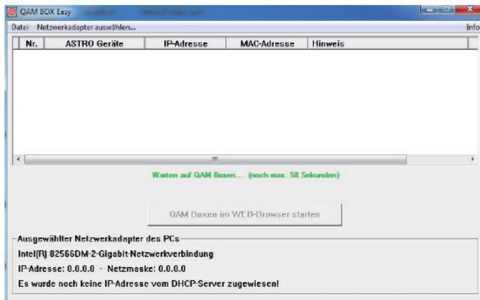
Starten Sie nun das zuvor installierte Easy-Programm. Sie sehen nun die Startoberfläche des Programms (siehe links). Es wird automatisch nach den IP-Adressen angeschlossener QAM BOX Module gesucht. Die verbleibende Zeit bis zum Abschluss des Suchvorgangs wird in grün angezeigt.
