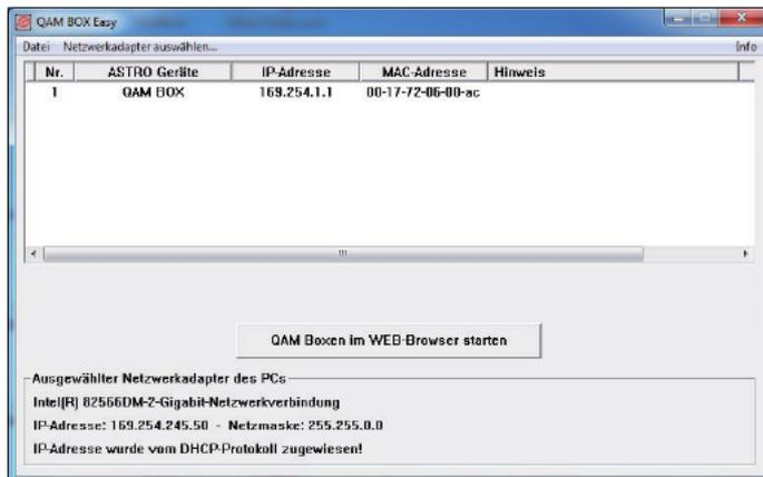
Sobald die Suche abgeschlossen ist, werden die MAC- und IP-Adresse der gefundenen QAM BOX Module in einer Tabelle aufgelistet.
