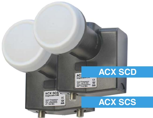
Mit den Einkabel-LNB **ACX SCD** und **ACX SCS** können Sie das empfangene SAT-ZF Signal über eine einzige Zuleitung an mehrere Teilnehmeranschlüsse verteilen. Es können bis zu 8 Teilnehmer (nach EN 50494) oder bis zu 24 Teilnehmer (nach EN 50607) versorgt werden.
