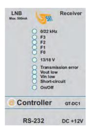
0 / 22 kHz: gelbe LED leuchtet, wenn 22 kHz-Ton am LNB-Ausgang anliegt
